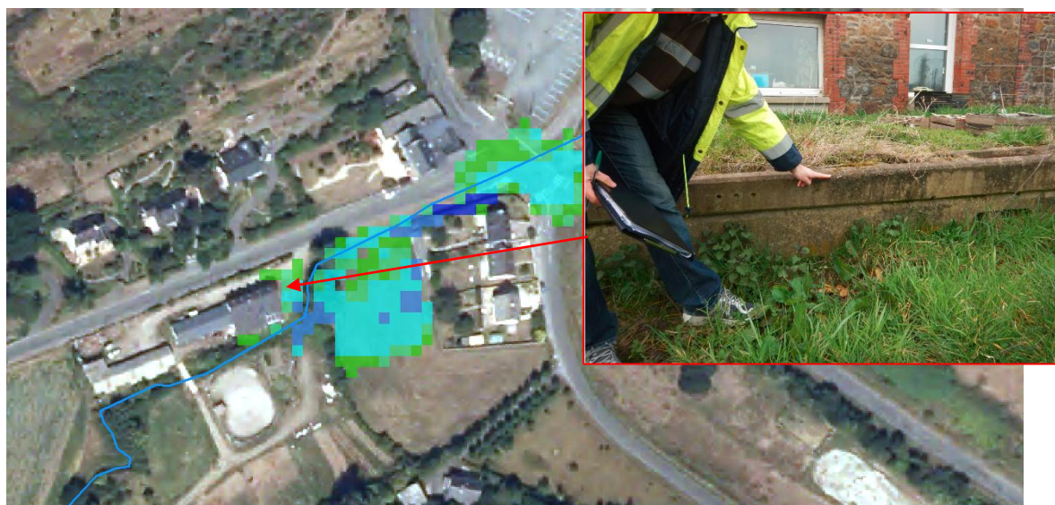
Figure 6-7. Localisation du repère de crue pour février 2010 (8.88 mNGF)
